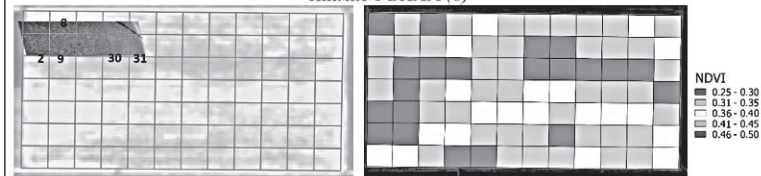
Рис. Привязка снимка с БПЛА по спутниковым данным (а) и ранжирование состояния растительности по NDVI (б)
