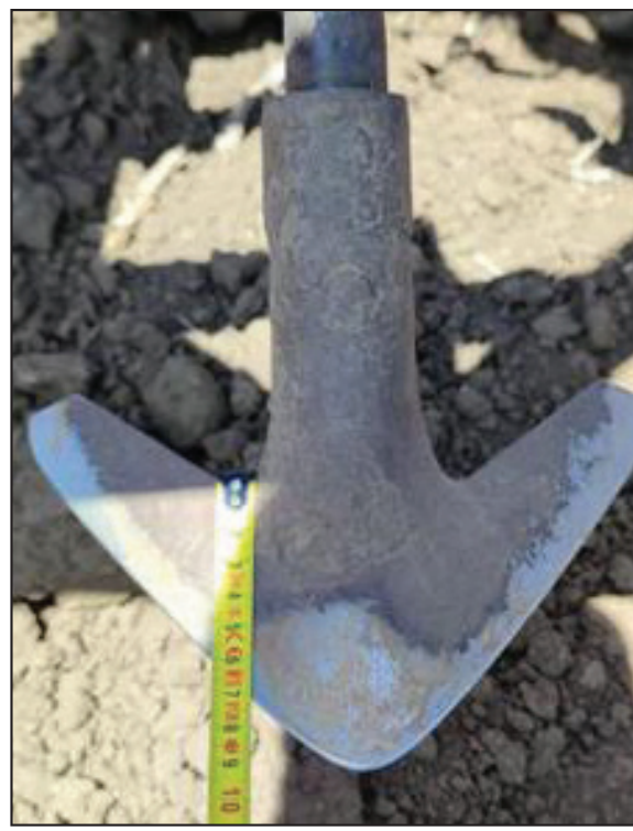
Рисунок 4. Общий вид стрелчатых лап блочно-модульного культиватора КПСОУ-8 с наработкой свыше 540 га: а) упрочненная стрелчатая лапа; б) серийная стрелчатая лапа.
