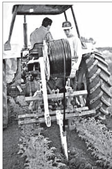
Бестраншейный внутрипочвенный укладчик поливных трубопроводов.
