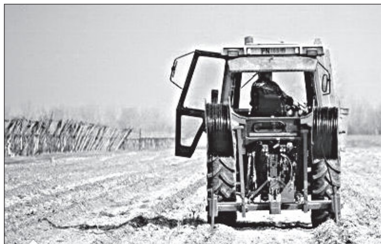
Двухрядное навесное устройство для прокладки труб в садах и виноградниках.
