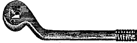
Рис. 128. Винтовой ключъ съ наръзкой для чистки винтового отверстия.
