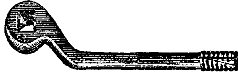
Рис. 128. Винтовой ключъ съ нарѣзкой для чистки винтового отверстия.
